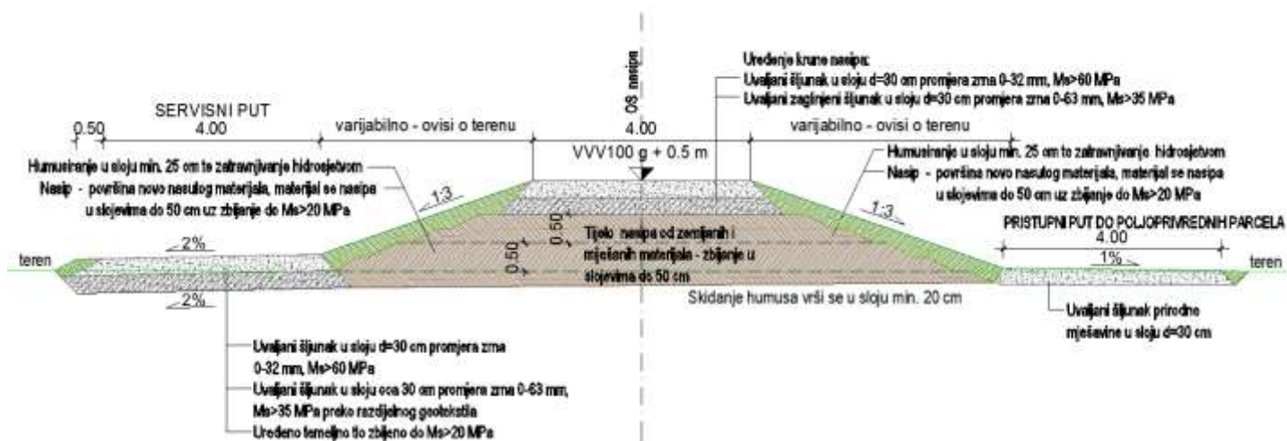
Slika 2.14 Karakteristični poprečni presjek nasipa u Selnica - Dubovica
